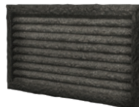
Onder invloed van warmte zet het opzwellende materiaal uit om verscheidene keren zijn oorspronkelijke dikte te bereiken en zo de doorgang van hitte en vlammen te verhinderen
